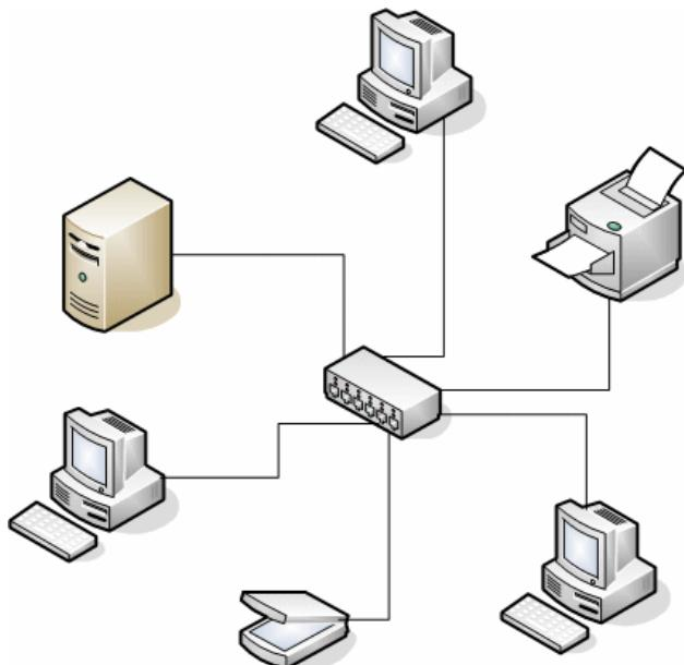
**Δίκτυο υπολογιστών** (*computer network*) λέμε κάθε σύλλογή υπολογιστικών συσκευών που συνδέονται μεταξύ τους με κάποιο **μέσο μετάδοσης** (ενσύρματα ή ασύρματα).
